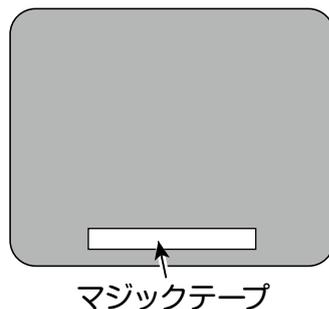
薄板の裏面に貼り付けてあるマジックテープで薄板と椅子をしっかり固定してください。
